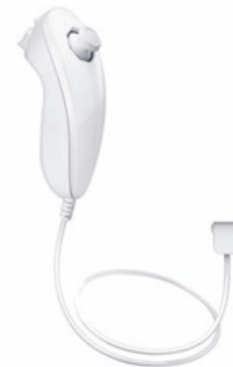
Wii Nunchuk: 3 axis accelerometer
